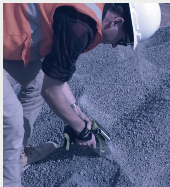
Un opérateur scannant un tas de minerai à l'aide de l'appareil xTrace™ à l'usine de traitement de Yacari.
